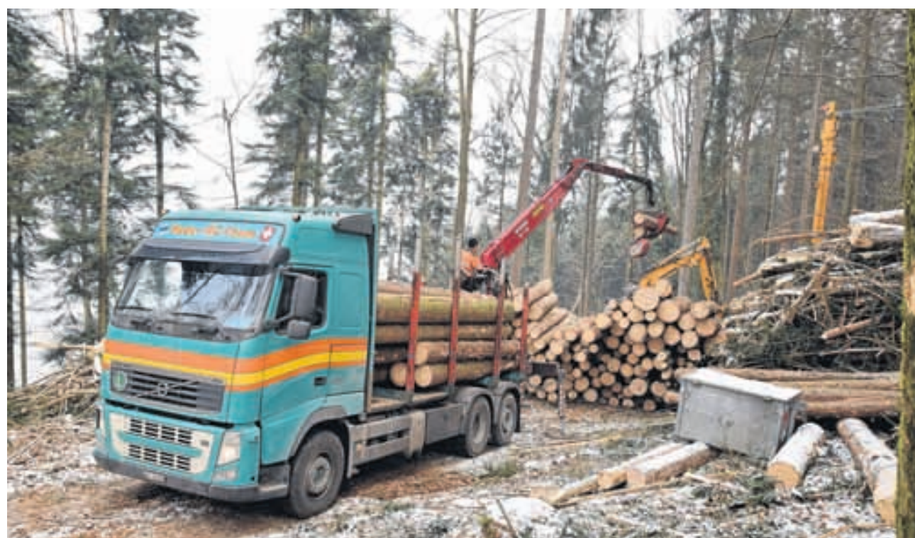
Die Seilbahn (im Hintergrund) befördert die Baumstämme im Gebiet Seewald zum Holzplatz. Dort wird das Windholz verladen und – anfänglich über eher schmale Waldwege – abtransportiert in eine Sägerei.
